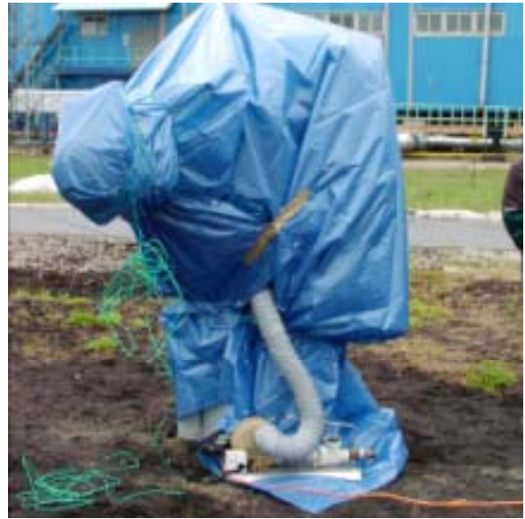
Foto 10: Volumenmessung an einer Armatur in Uchta, Juni 2003.
