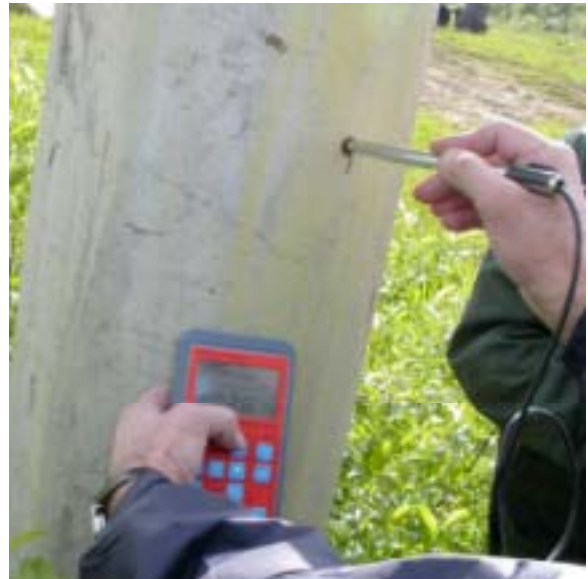
Foto 6: Messung mittels Thermo-Anemometer.
